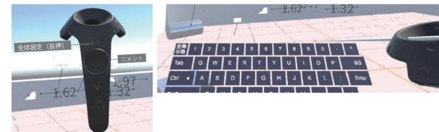
点群内の任意の位置へのタグ付け（現場データの危険個所の安全確認等に）やコメントの入力も VIVE コントローラで操作できる
